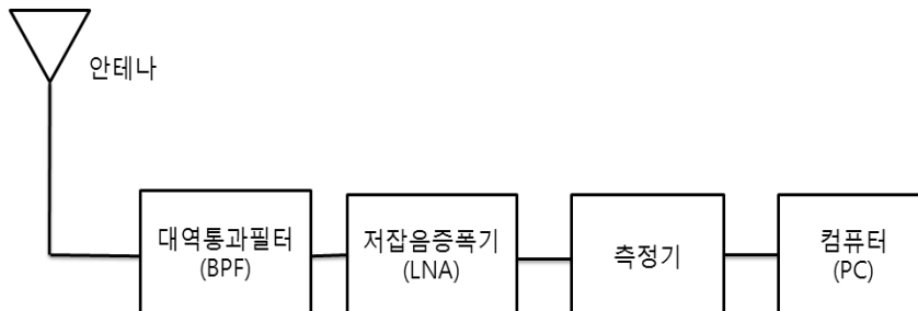
(그림4-13) 전파잡음 측정시스템 구성도
