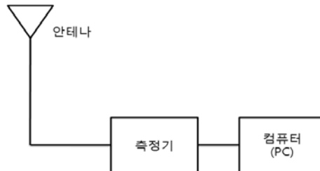
(그림4-14) 전파잡음 측정대상 주파수 선정을 위한 측정시스템 구성도
