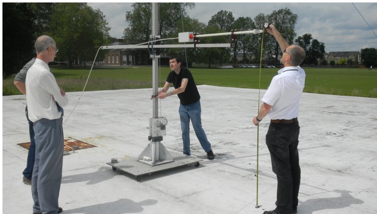
<그림 2-3-29> NPL 계산형 표준 안테나의 설치
