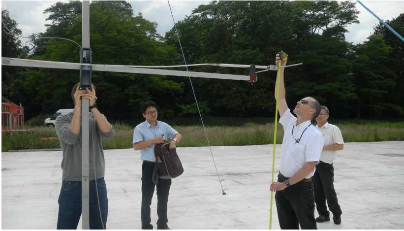
<그림 2-3-32> NPL 표준 안테나를 우리원의 안테나로 치환 설치
