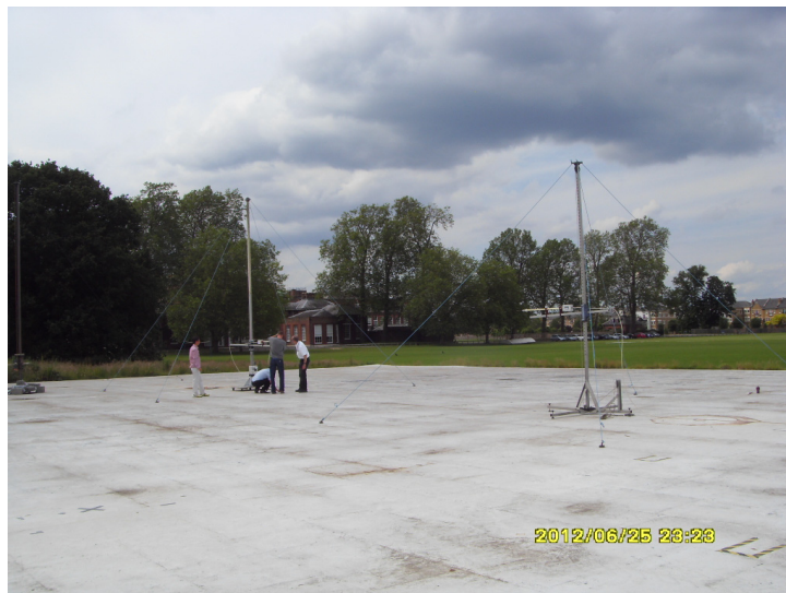
<그림 2-3-28> NPL 안테나 교정시험장 : 40 m × 60 m 금속면
