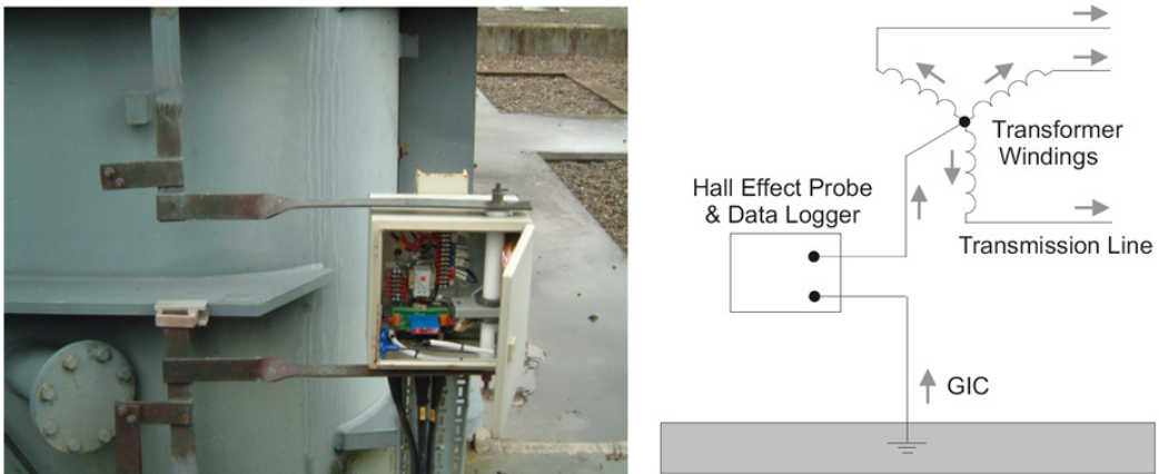
[그림 45] 스코틀랜드 전력망 유도전류 측정 센서 (Hall Effect Transducer Type)
