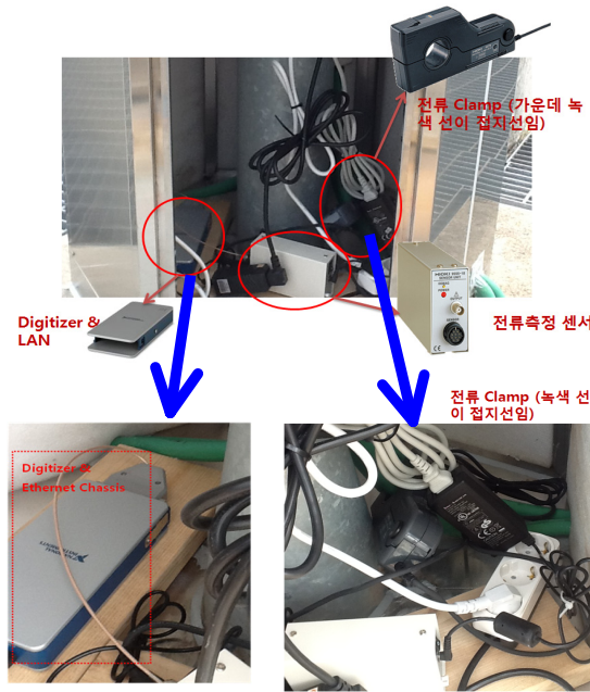
[그림 52] 지자기 유도전류 측정을 위한 Clamp 및 Sensor등 설치 모습
