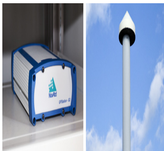
[그림 3] 전리층 전자밀도 관측시스템
