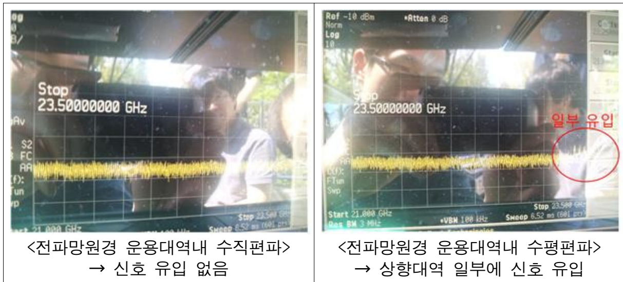
[그림 3-36] 차량충돌방지용 레이더의 전파스펙트럼 측정결과
