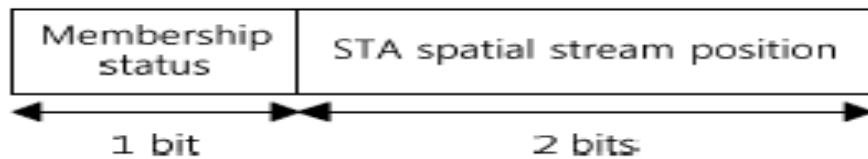
[그림 3-26] Group ID의 Assignment 구성 정보
