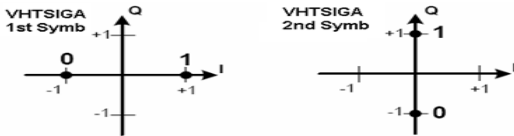
[그림 3-19] VHT-SIG-A의 데이터 매핑 방법
