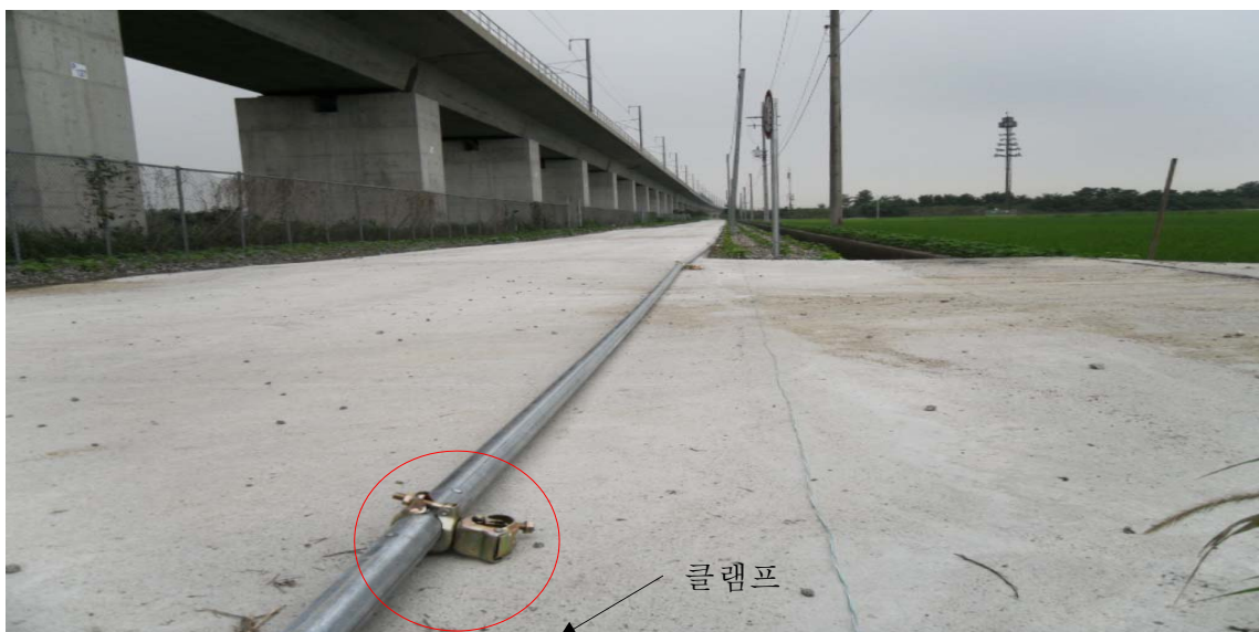
(그림3-32) 강관재료 연결 실험 설치 현장(사진)
