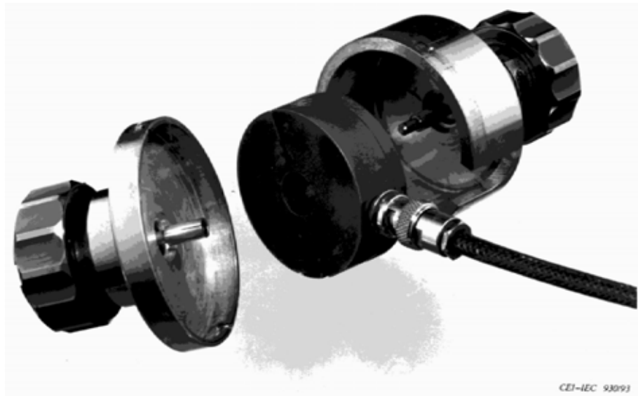
그림.B.8b 동축어댑터의 두개의 절반부 사이에 있는 전류 프로브
