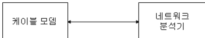
그림 3 — 시험 장비의 연결 구성
