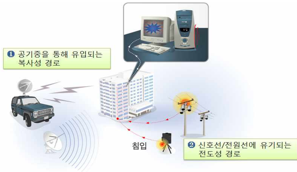
< ① 복사성, ② 전도성 > 그림 2-6 복사성 및 전도성 침입 경로
