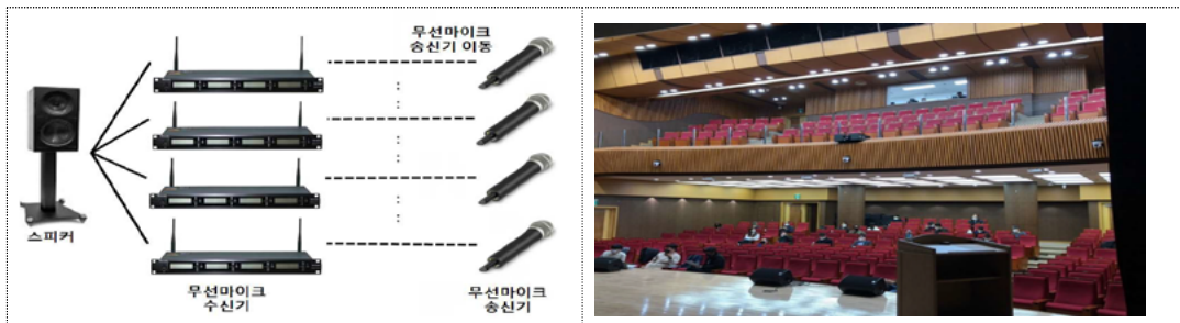
[ 그림 3.3] 무선마이크 RF 성능 확인 실험 구성 및 환경
