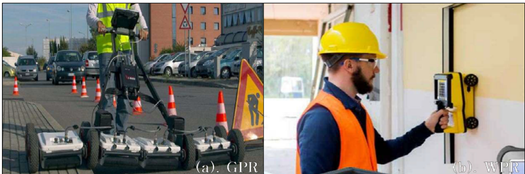
[그림 3.17] 지표투과레이다(a)와 벽투과레이다(b)의 형태
