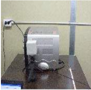
(a) 우측면 1/3 지점 (b) 우측면 2/3 지점 (c) 우측면 3/3 지점 그림 3-8 미니오븐 전자파 측정 사진
