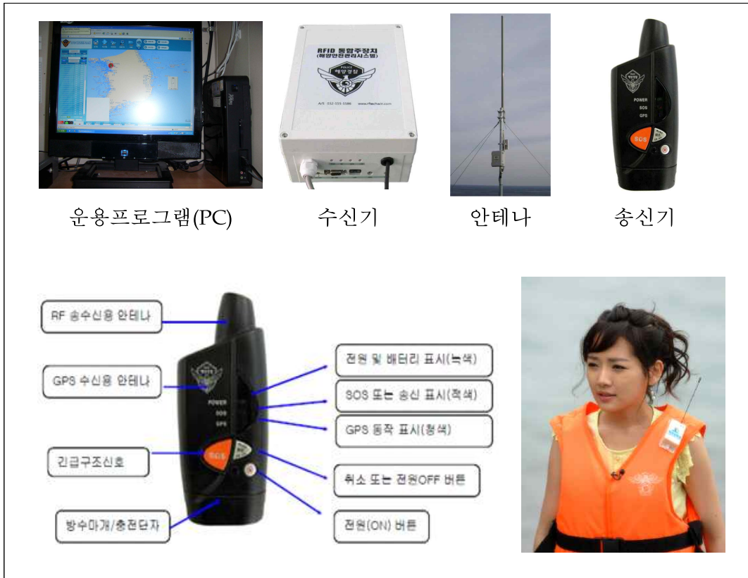
[그림 4-4] 라이프자켓용 RFID 구성 및 착용예
